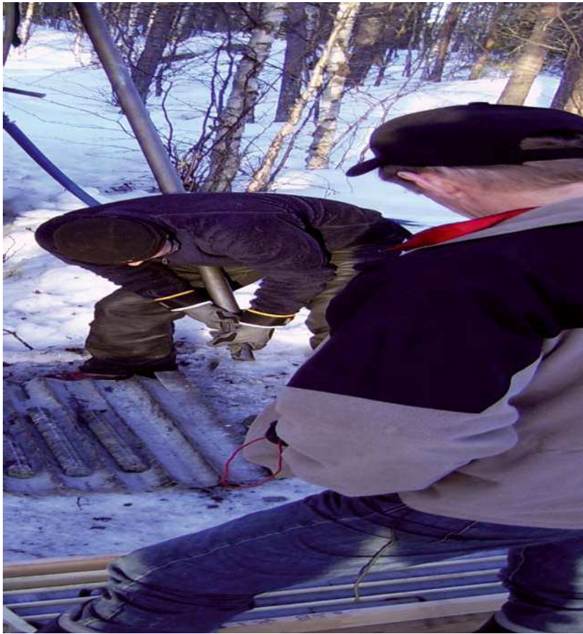
Genomgång av borrhörnorna från diamantborrningen vid Botnia Explorations inmutning i Orgsjön.
